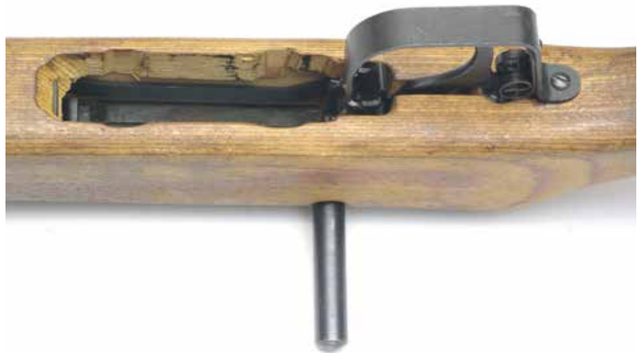
De VG1 had kaliber 7,92 x 57 mm en gebruikte K43 magazijnen. Het magazijn werd geleid door twee inwendige beugels. De opening in de lade was grof uitgestoken. De magazijnpal zit voorin de trekkerbeugel. (Finnish Arms Museum Foundation)
