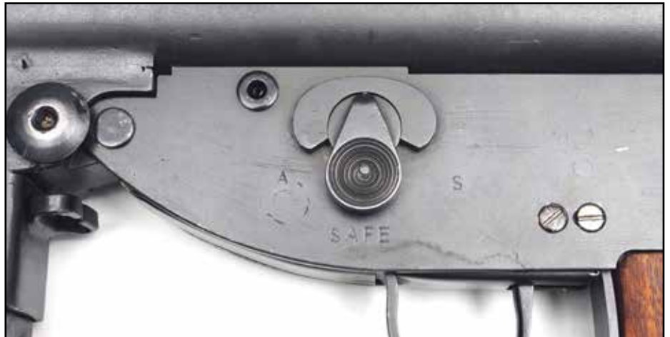
Close-up van de veiligheid annex vuurschakelaar van de R.O.F. Sten. De pal heeft drie standen: automatisch (A - links), veilig (SAFE - midden) en semiautomatisch (S - rechts). Anders dan bij de Sten kan de spangreep niet in zijn achterste stand worden vastgezet.
