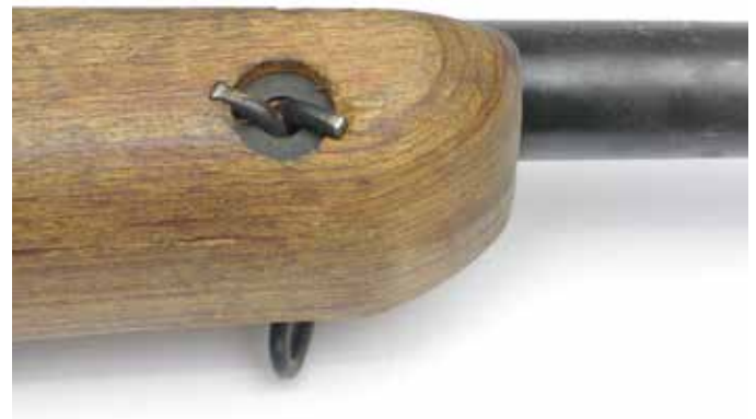
Alles aan de VG1 was zo simpel mogelijk, zoals bijvoorbeeld de voorste riembeugel: een omgevouwen stuk staaldraad. (Finnish Arms Museum Foundation).
