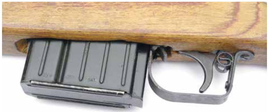
De VG1 had kaliber 7,92 x 57 mm en gebruikte K43 magazijnen. Het magazijn werd geleid door twee inwendige beugels. De opening in de lade was grof uitgestoken. De magazijnpal zit voorin de trekkerbeugel. (Finnish Arms Museum Foundation)
