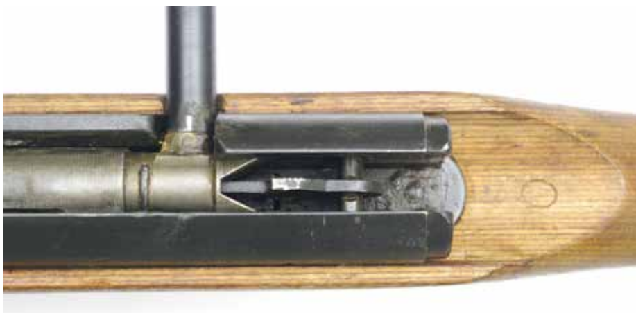
Bovenaanzicht van een VG1 met het slot ontspannen (boven) en gespannen. De slagpin en haan zijn gemaakt uit één stuk staalplaat. (Finnish Arms Museum Foundation)
