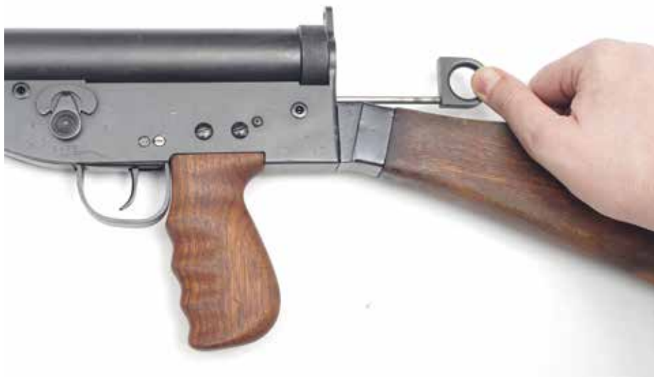
De R.O.F. Sten heeft geen normale spangreep, maar een oog achterop de kast, waarmee de afsluiter achteruit wordt getrokken.
