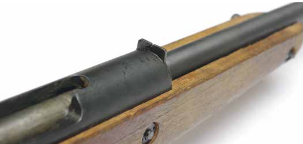
De simpele U-vormige keep zit op een plaatje dat om de loop is geschoven. (Finnish Arms Museum Foundation)
