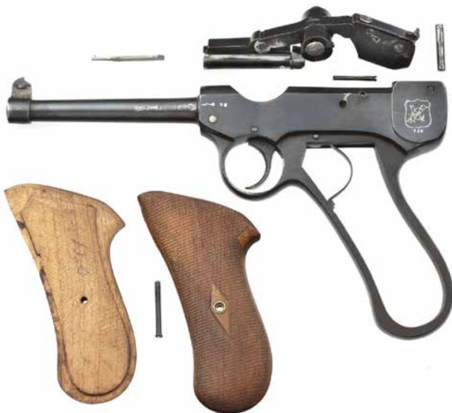
Het Francotte-Weber pistool in hoofddelen: afsluiter met het kniegewricht, kast, greepplatten en de verschillende schroeven en stiften.
