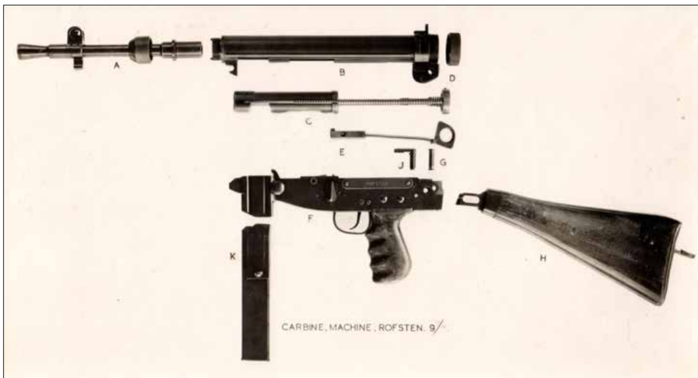
In 1948 werd een exemplaar van de R.O.F. Sten in Enfield getest. Deze foto van het wapen in onderdelen is waarschijnlijk bij gelegenheid van die test genomen. (Archief SAM)
