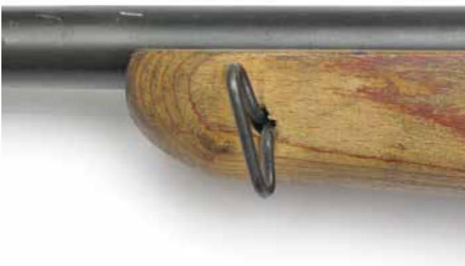
Alles aan de VG1 was zo simpel mogelijk, zoals bijvoorbeeld de voorste riembeugel: een omgevouwen stuk staaldraad. (Finnish Arms Museum Foundation).
