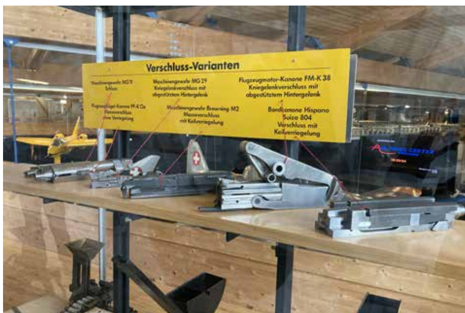
Verschiede afsluiters van vliegtuigmitrailleurs, met uitleg.
