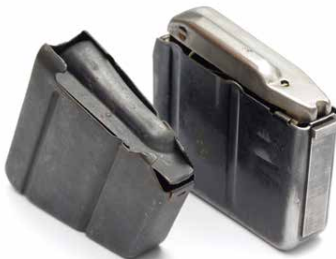
Verschillende vormen van de aanbrengrer, in een Lee-Enfield magazijn (links) en een SAFN magazijn. Die laatste hoort hier eigenlijk niet thuis. Het magazijn is wel afneembaar, en heeft ook een aanvoermecanisme, maar het kan alleen geladen worden als het in het wapen zit. (Privécollectie)
