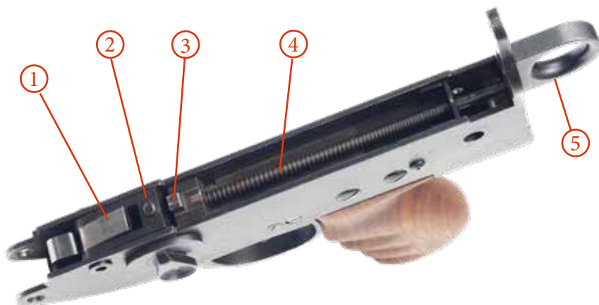
De pistoolgreep schuin van boven met 1. tuimelaar; 2. nok van de veiligheidspal; 3. spanknok; 4. stang en veer van de spangreep; 5. spanoog.
