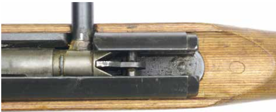
Bovenaanzicht van een VG1 met het slot ontspannen (boven) en gespannen. De slagpin en haan zijn gemaakt uit één stuk staalplaat. (Finnish Arms Museum Foundation)
