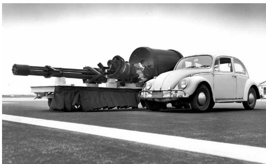
Het principe van de Gatling kan voor tal van kalibers worden gebruikt, van 5,56 mm tot deze 30 mm Gau-8/A Avenger, die onder meer wordt dient als bewapening in de Fairchild Republic A-10 Thunderbolt II en als Goalkeeper CIWS op schepen. Ter vergelijking een Volkswagen Kever.
