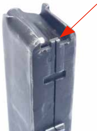
De uitwerper van de Owen zit niet in de kast, maar is onderdeel van het magazijn (pijl).
