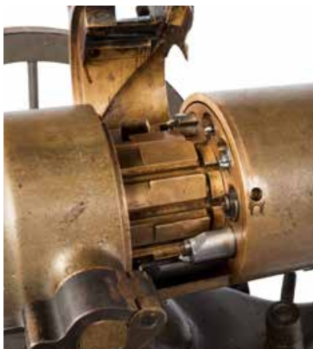
De aanvoertrommel van de Gatling mitrailleur (hier de tienloops versie), met rechts een aantal van de afsluiters. Het principe is gelijk aan dat van de moderne Minigun.
