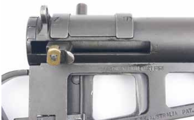
De toegevoegde veiligheid op de Owen MK 2/3: een schuif die de opening van de spangreep bedekt en de beweging van de spangreep blokkeert.
