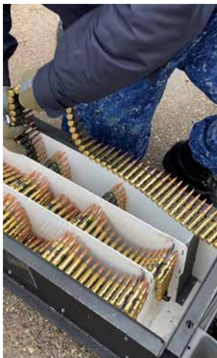
Een wapen met zo'n hoge vuursnelheid heeft véél munitie nodig. Dillon Aero levert munitiekisten voor maximaal 4400 patronen met twee of drie compartimenten.
