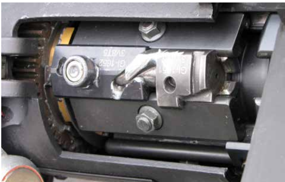
Een van de afsluiters in zijn ligplaats. De rol op de afsluiter ligt in de geleider. Als het wapen draait worden de afsluiter daardoor heen en weer bewogen.
