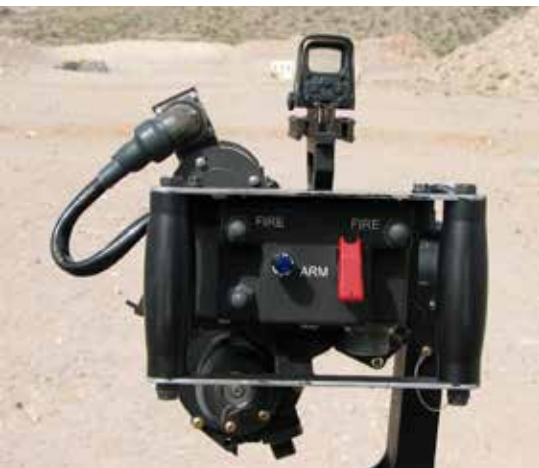
Achteraanzicht van het wapen, met de schakelaar voor de motor en de afvuurknoppen. Hier-van bestaan verschillende uitvoeringen.
