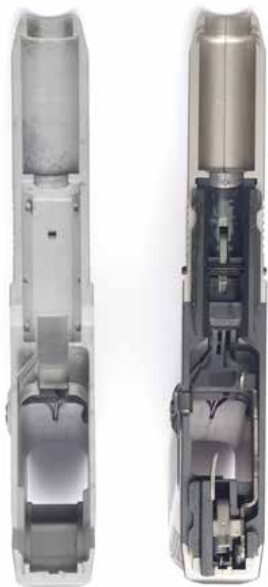
Bovenaanzicht van de kast. Links de kunststof versie zonder chassis, rechts de aluminium versie met chassis.
