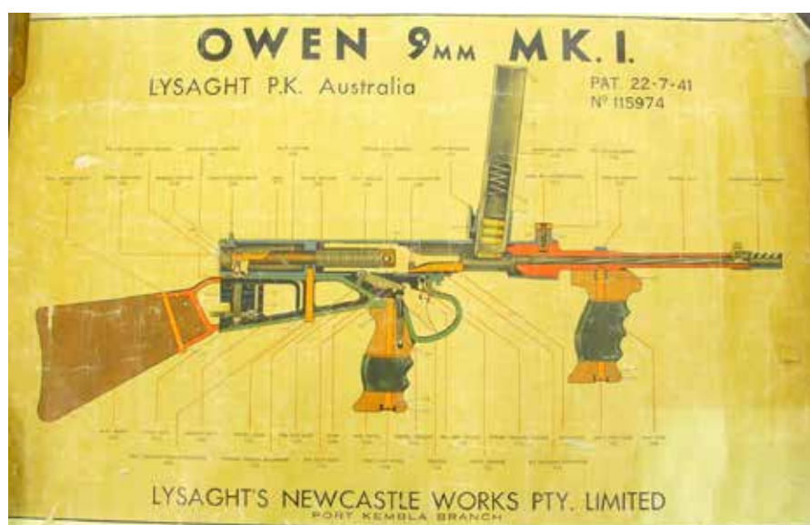
Een instructieplaat van de Owen, waarschijnlijk uit 1943. Ondanks de modelbenaming MK. I, heeft de loop geen koelribben meer en is het trekkerhuis opengewerkt.
