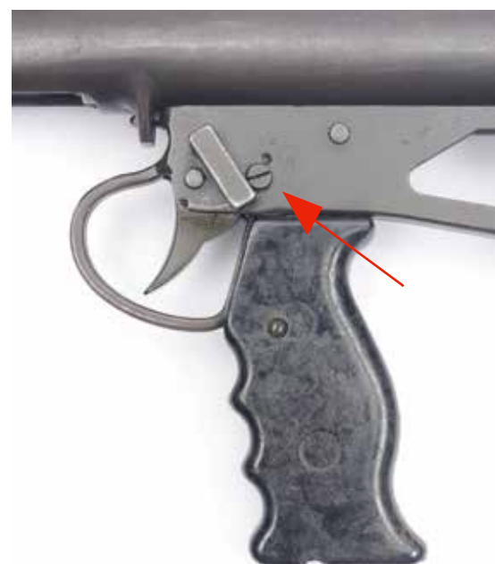
Met de toevoeging van de veiligheidsschuif werd de stand 'S' van de vuurselector door een schroef (pijl) geblokkeerd.
