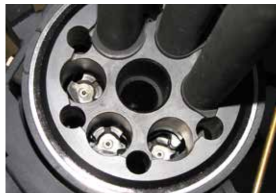
Vooraanzicht van de lopenbundel, met drie van de zes lopen verwijderd.
