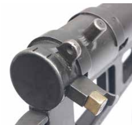
Als de veiligheidsschuif is gesloten, ligt zijn knop precies voor de diopterkeep. De schutter merkt dus direct dat zijn wapen op veilig staat.
