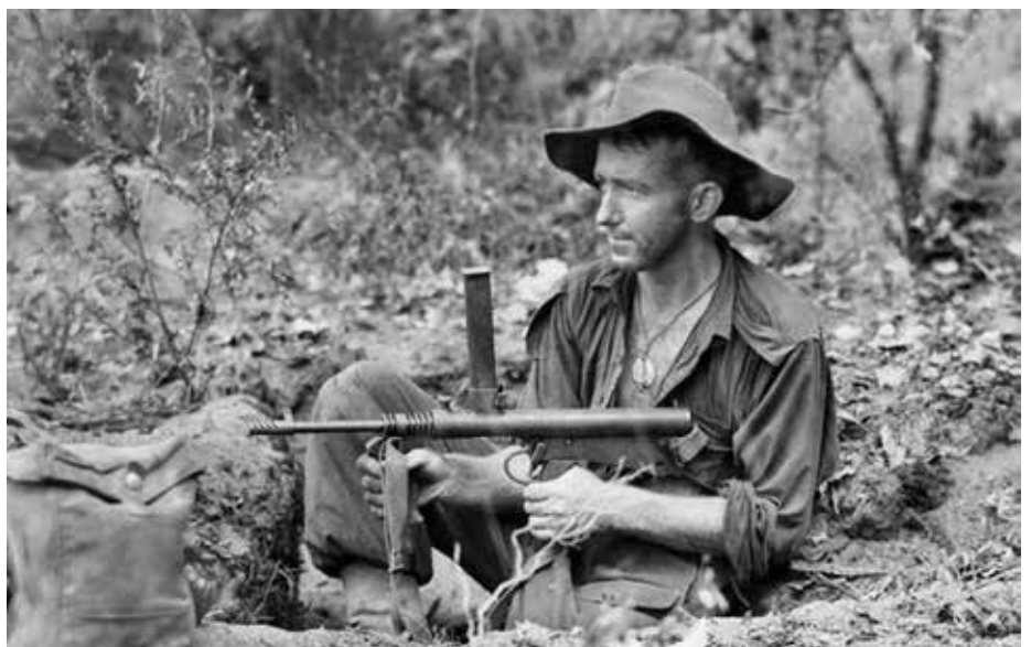
De eerste versie van de Owen in de jungle. Het wapen heeft de loop met koelribben, en een dicht trekkerhuis, maar wel de metalen skeletkolf. De Owen bleek nagenoeg ongevoelig voor modder en vuil.
