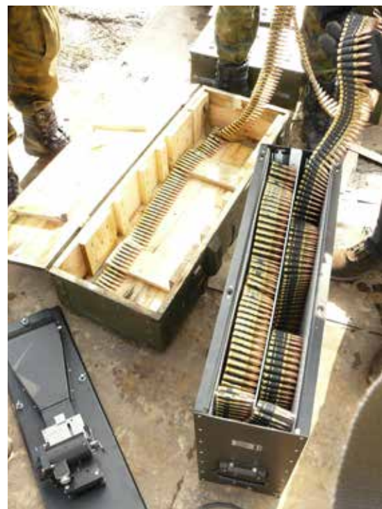
Een wapen met zo'n hoge vuursnelheid heeft véél munitie nodig. Dillon Aero levert munitiekisten voor maximaal 4400 patronen met twee of drie compartimenten.
