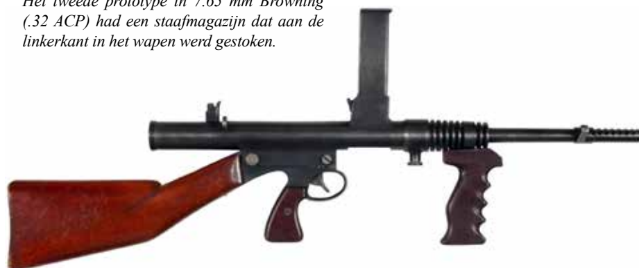
Dit prototype in kaliber .45 ACP heeft al veel kenmerken van het latere productiemodel, inclusief de patroonaanvoer van bovenaf.
