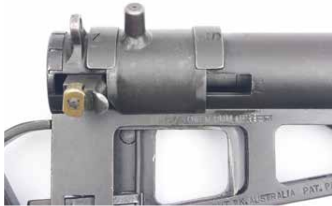
De toegevoegde veiligheid op de Owen MK 2/3: een schuif die de opening van de spangreep bedekt en de beweging van de spangreep blokkeert.
