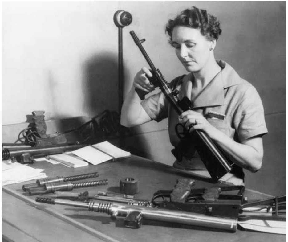
Inspectie van Owen pistoolmitrailleurs na de assemblage, bij Lysaght Newcastle Steelworks.
