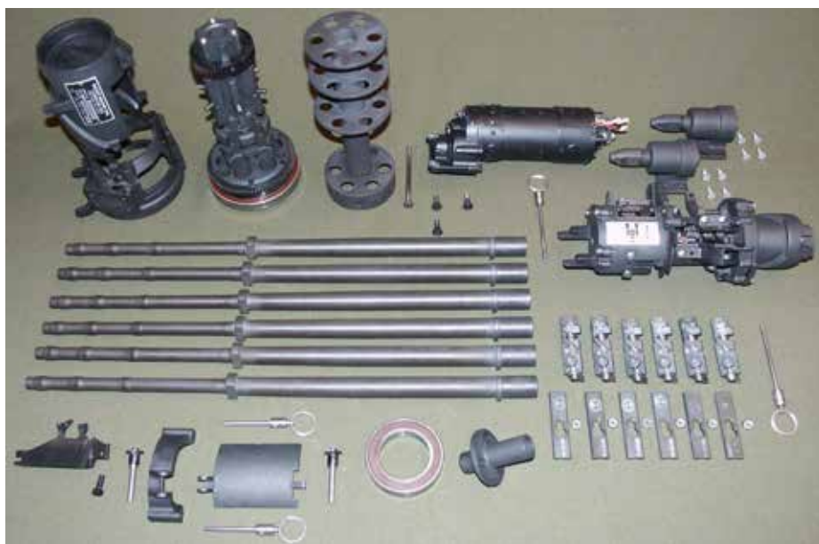
Een Minigun in hoofddelen. In dit geval is het wapen gemaakt door de Amerikaanse firma deGroat. In het midden de lopen, rechts de zes afsluiters.
