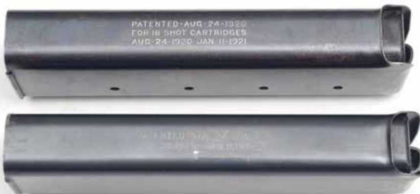
Het bovenste magazijn is voor speciale .45 hagelpatronen. Deze waren langer dan de standaard .45 ACP patroon, en dus is het magazijn ook langer. Vanwege de bevestigingsrib op de rug van het magazijn maakte dat niet uit. (Privécollectie)
