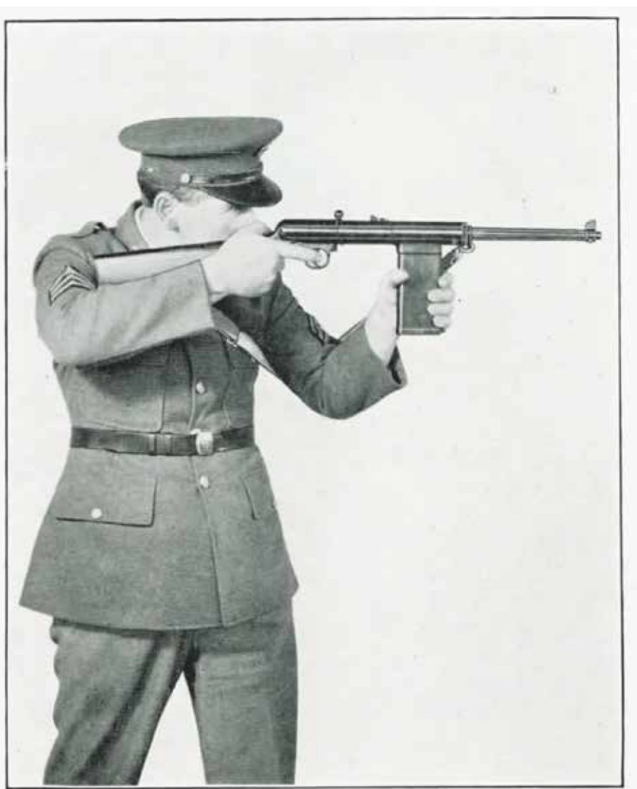
Het Light Rifle in de aanslag, op een foto uit de handleiding. Het gecombineerde magazijnhuis/uitwerptunnel dient als voorste handgreep.
