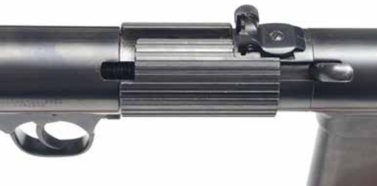
Bij de Mark II is de veiligheidspal vervangen door een draaibare manchet. Op deze foto's staat hij gezekeerd (links) en ontzekeerd van rechts. Let op de uitsparingen voor het vizier. (Privécollectie)
