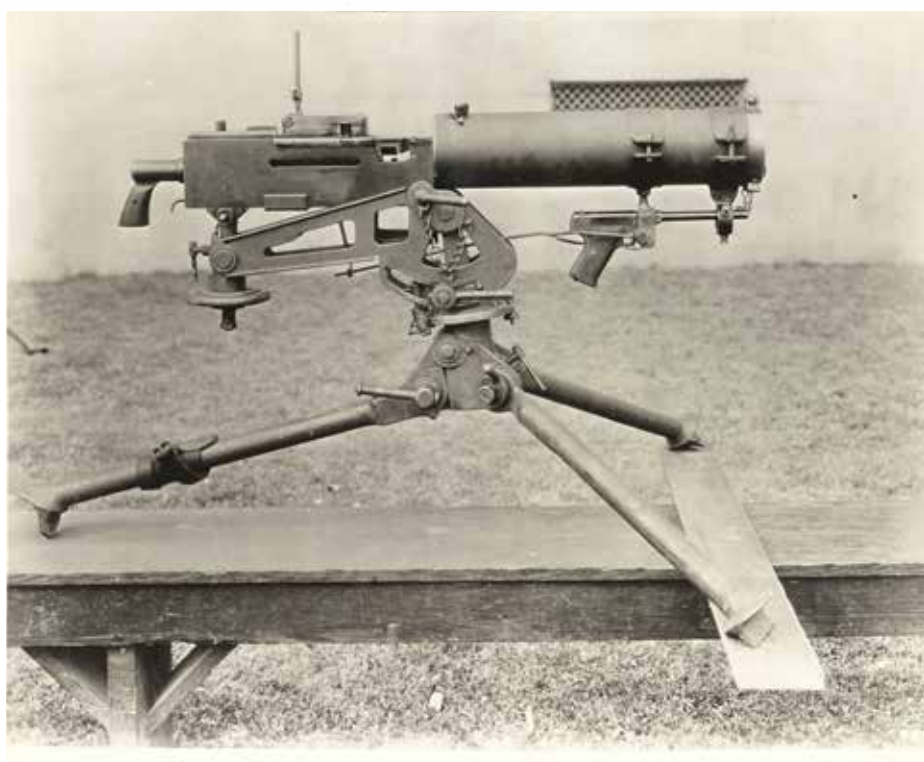
De M1917 van rechts, ook hier zonder lamp. Het pistool wordt afgevuurd via een stang die naar achteren loopt, maar helaas is niet te zien hoe deze eindigt. (National Archives. No. 098228)
