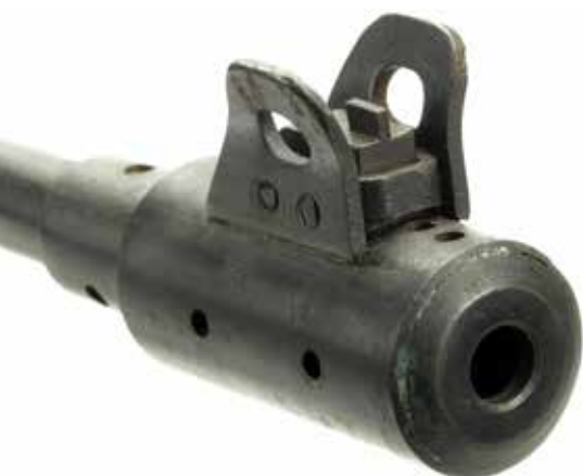
De monding is voorzien van een eenvoudige compensator en een goed beschermde korrel.
