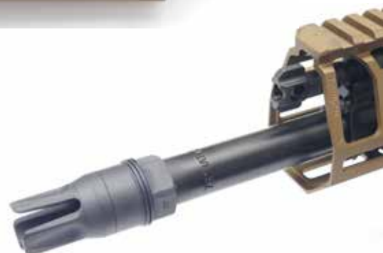
De gasregelaar van de MCX-SPEAR heeft twee standen: Normal en Surpressed. Op de voorkant van de handbeschermers is aangegeven welke kant de gasregelaar voor elk van beide standen opgedraaid moet worden. De gasregelaar zelf steekt aan de voorkant uit de handbeschermers en is daarmee goed bereikbaar.
