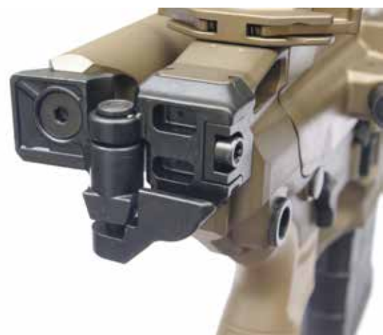
Close-up van het scharnierpunt, met de kolf omgeklapt.
