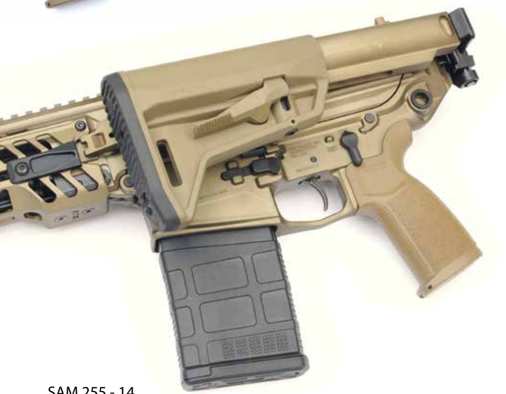
Dankzij de volledig in de kast geplaatste sluitveer, kan de MCX-SPEAR een omklapbare kolf hebben. De Magpul SL-M is kolf ook nog eens over zes standen verstelbaar. Op de bovenste foto is de kolf volledig uitgeschoven.
