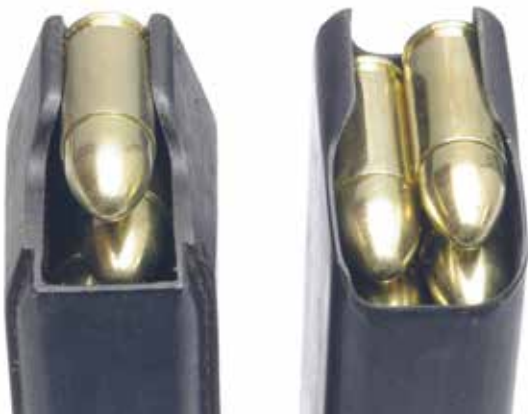
Een dubbelrijig magazijn met centrale aanvoer (links) en een dubbelrijig magazijn met dubbelrijige aanvoer. De laatste is gemakkelijker te laden en geeft minder problemen bij de patroonaanvoer.
