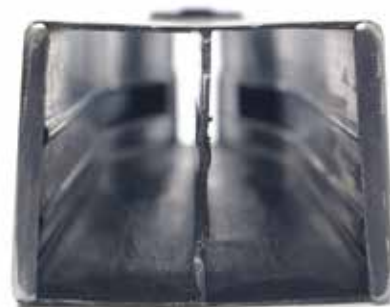
De binnenkant van het Schillström magazijn, gezien van onderen. De twee delen zijn gescheiden door een middenschot. (Privécollectie)
