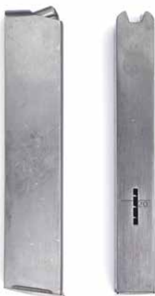
Het 20-schots magazijn van het Light Rifle van rechts en van achteren. Het magazijn is niet gemerkt of genummerd. (Privécollectie)
