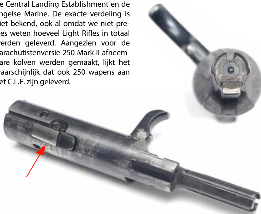
De afsluiter van de Mark II met vaste slagpin, van voren en schuin van onderen. De pijl wijst naar de tuimelaar, die anders dan bij de meeste wapens in de afsluiter zit. (Privécollectie)
