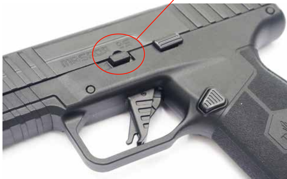
De Masada Slim heeft een andere manier van demonteren: een as moet naar links uit de kast worden gedruwd, en daarvoor moet eerst een dekseltje opzij worden geschoven
