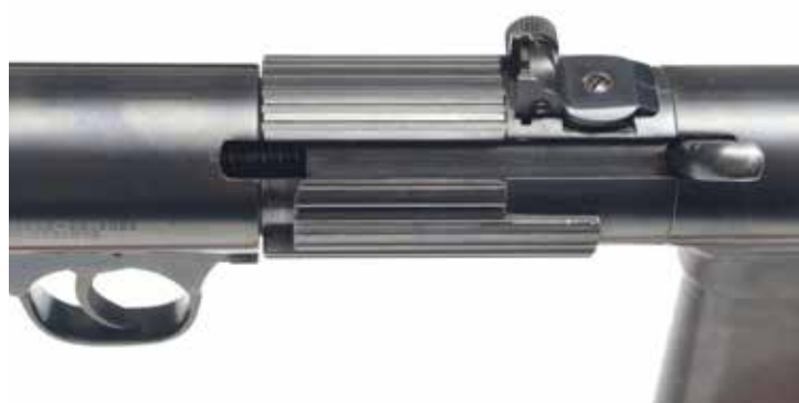
Bij de Mark II is de veiligheidspal vervangen door een draaibare manchet. Op deze foto's staat hij gezekeerd (links) en ontzekeerd van rechts. Let op de uitsparingen voor het vizier. (Privécollectie)
