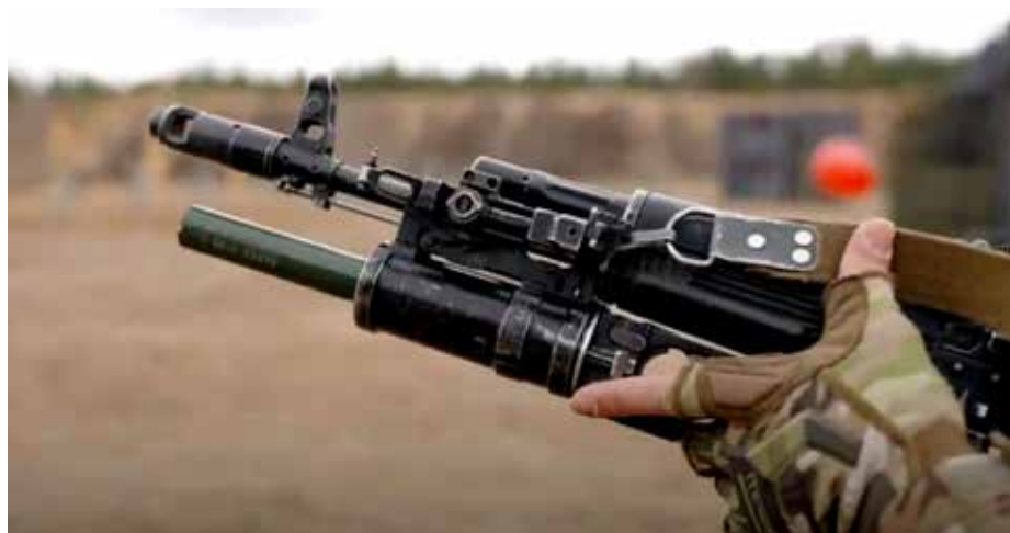
'Rosyanka schietapparaat', een kaliber 12/76 mm insteekloop voor de GP-25 granaatwerper (Ingra)
