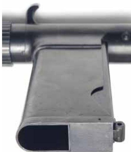
Het 20-schots magazijn van het Light Rifle van rechts en van achteren. Het magazijn is niet gemerkt of genummerd. (Privécollectie)
