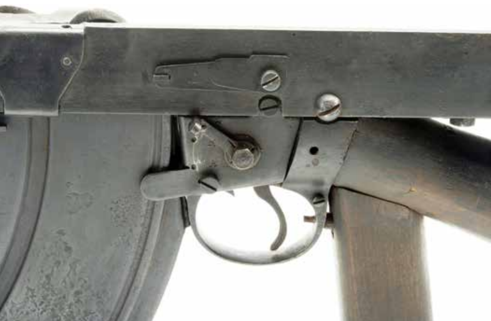
De vuurschakelaar links boven de trekker, met de standen S, R en A, voor veilig, semiautomatisch en automatisch vuur.
