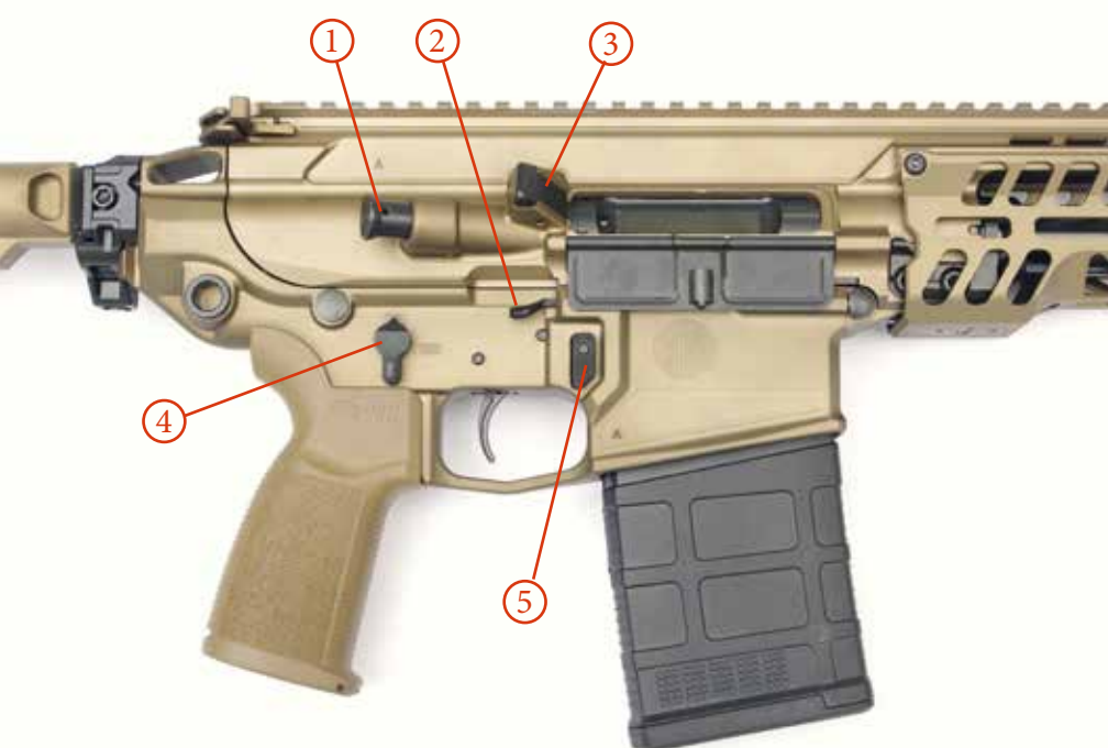
Close-up van de rechterkant van de kast met 1. Forward bolt assist; 2. Afsluiterpal; 3. Deflector; 4. Veiligheidspal en 5. Magazijnpal.
