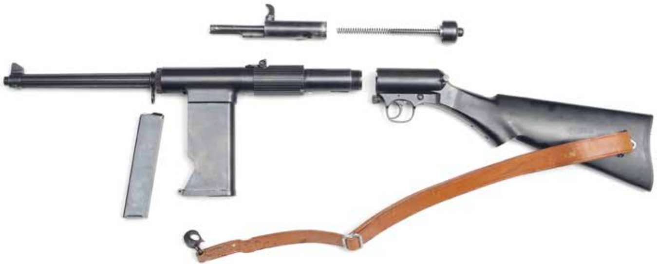
De Smith & Wesson Mark II in hoofd delen. Van boven naar beneden: Afsluiter, sluitveer, sluitveerstang en dop, loop met kast, magazijn, en kolf met staartstuk. (Privécollectie).
