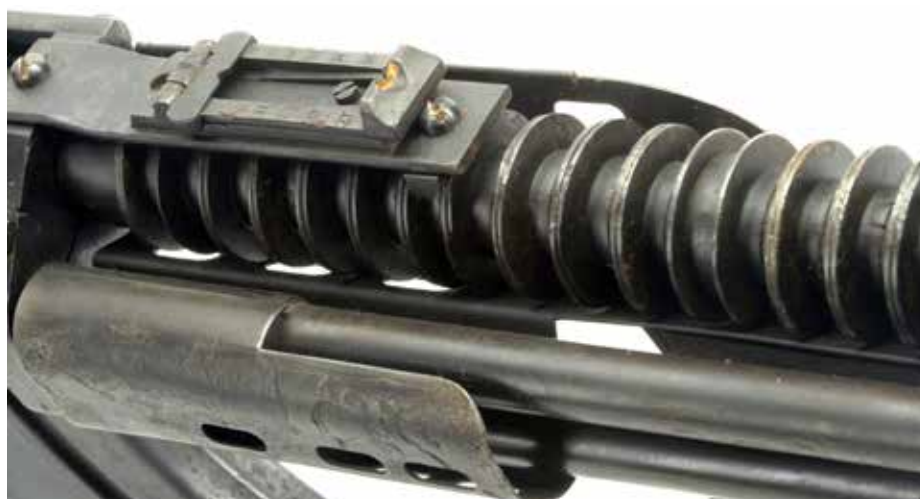
De koelribben bestaan uit afzonderlijke gestante ringen van plaatstaal die over de loop zijn geschoven en vervolgens samengeperst. Het vizier zit op een plaatje dat op de loop is geschroefd.
