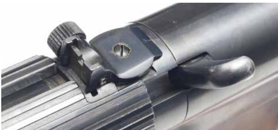
Close-up van de vizierkeep (links) en de korrel. (Privécollectie)
