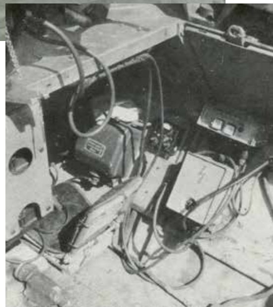
De Sd.Kfz. 251 pantserwagen met FG 1250 en FG 1252 droeg de aanduiding 'Falke'. Eén apparaat was voor de bestuurder, een tweede voor de MG42. Rechts: De elektrische installaties in een Sd.Kfz. 251 'Falke'.
