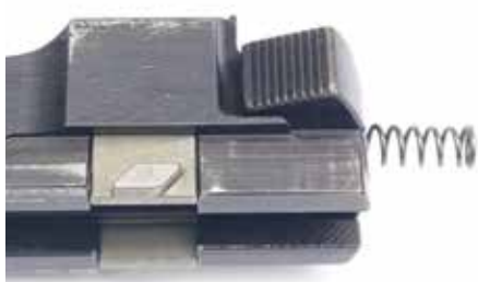
In zijn onderste stand houdt het grenzelblokje staartstuk en afsluiter met elkaar verbonden. Als het grenzelblokje via zijn afgeschuinde nokken wordt opgetild, kan de afsluiter verder achteruit.
