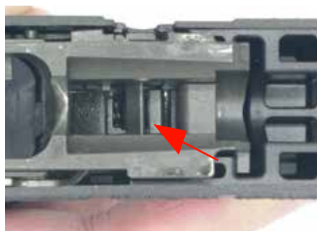
Als de trekker wordt overgehaald draait 'trekker No. 1' (pijl) waardoor de trekkerstang naar voren gaat.
