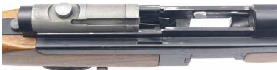
De M.1945 schuin van boven, zonder slede, met de afsluiter in zijn voorste en achterste stand.
