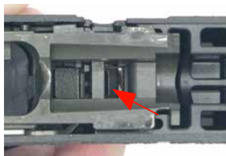
Als de trekker wordt overgehaald draait 'trekker No. 1' (pijl) waardoor de trekkerstang naar voren gaat.
