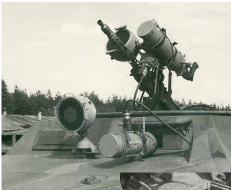
De Sd.Kfz. 251 pantserwagen met FG 1250 en FG 1252 droeg de aanduiding 'Falke'. Eén apparaat was voor de bestuurder, een tweede voor de MG42. Rechts: De elektrische installaties in een Sd.Kfz. 251 'Falke'.
