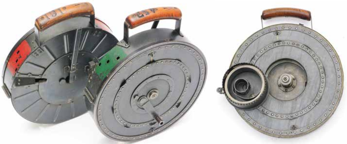
De 180-schots trommels van de Gast mitrailleur. De kleuren zijn om de linker en rechter trommel gemakkelijker te kunnen onderscheiden.
