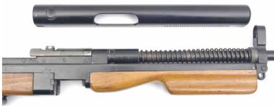
Close-up van het huis met daarboven de slede. De afsluiter ligt achter het loopblok. De sluitveer zit om de loop.
