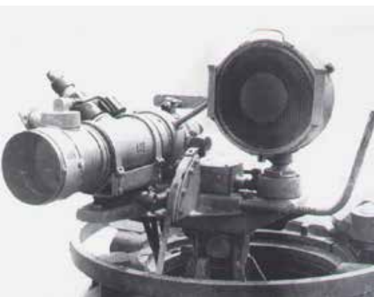
De Sd.Kfz. 251 pantserwagen met FG 1250 en FG 1252 droeg de aanduiding 'Falke'. Eén apparaat was voor de bestuurder, een tweede voor de MG42. Rechts: De elektrische installaties in een Sd.Kfz. 251 'Falke'.
