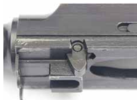
Close-up van de accelerator. Boven met het wapen gesloten, onder als de kast de onderste arm van de accelerator naar voren heeft geduwd.
