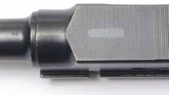
Bij dit m/40 pistool is duidelijk te zien dat de ligplaats van de laadindicator is weggeslepen, en de opening is opgevuld. (Collectie Van der Linden)
