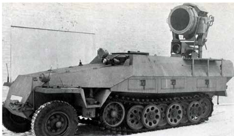
Sd.Kfz. 251 'Uhu'. De 60 cm UR lamp kon 360° worden gedraaid. De bestuurder had een aparte FG 1250 voor oriëntatie 's nachts.
