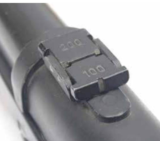
De Madsen heeft een dubbele, omklapbare vizierkeep voor afstanden van 100 en 200 meter.
