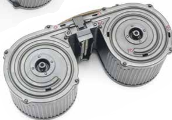
Voor- en achteraanzicht van een zadelmagazijn voor de MG15 vliegtuigmitrailleur.
