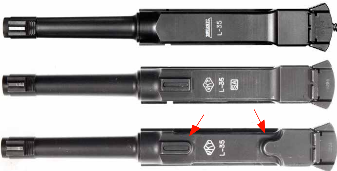
Drie versies van het L-35 pistool. Onder het eerste model met een afgeronde ligplaats van de laadindicator (pijl links) en een ligplaats voor de hulpveer van het grendelblok (pijl rechts). In het midden de versie met versterkte slede, zonder ligplaats van de hulpveer en met een rechthoekige ligplaats van de laadindicator; en boven de naoorlogse Valmet zonder hulpveer en laadindicator: (Foto J. Krcma)
