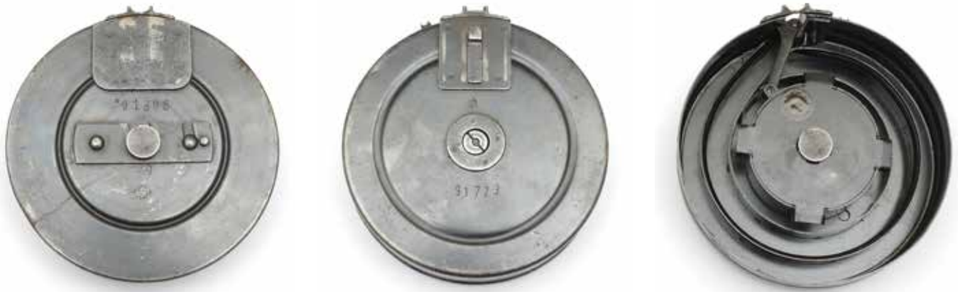
Het Suomi trommelmagazijn van voren, van achteren en van binnen. De sterke bladveer zorgt voor de aanvoer van de patronen.
